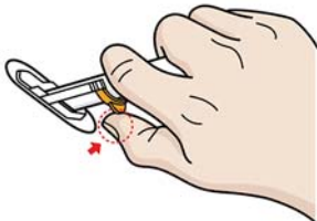
Obrázek 17. Odstraňte pojistku zámku zavaděče
